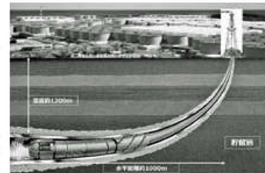
水平井概念図/石油鉱業では確立された掘削方法である
